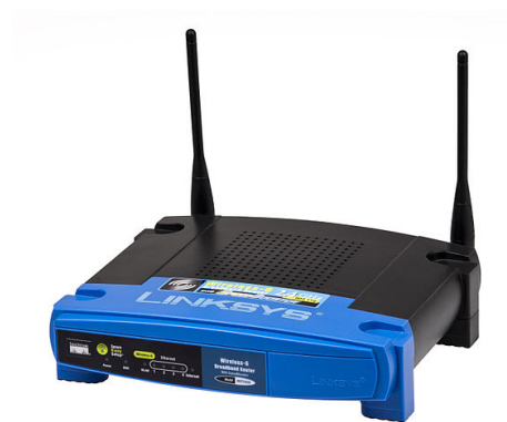
Figur 34: Router för hemmabruk sammanbyggd med en switch och en trådlös accesspunkt Foto: Wikimedia commons användare Evan-Amos Från Wikimedia Commons.
